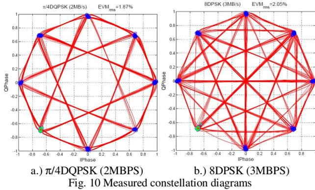
a.)  $\pi/4$ DQPSK (2MBPS) b.) 8DPSK (3MBPS)
