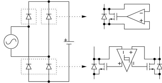
Fig. 6. Synchronous rectifier circuit
